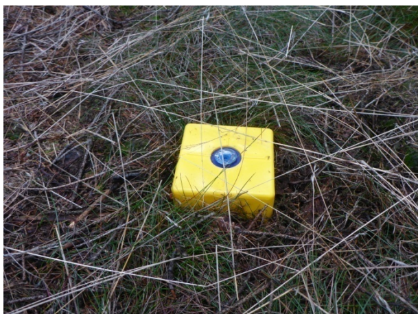
Roh DP fixovaný geodetickým mezníkem
