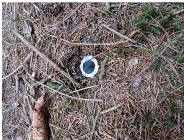
Fotobod fixovaný ocelovou trubkou
