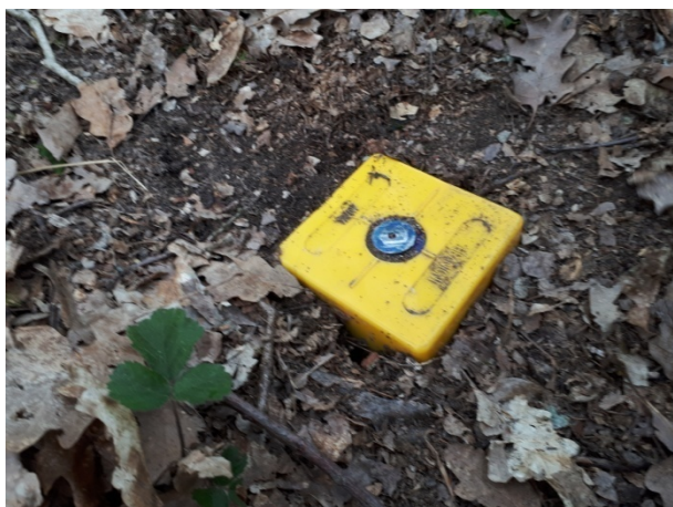
Roh DP fixovaný geodetickým mezníkem
