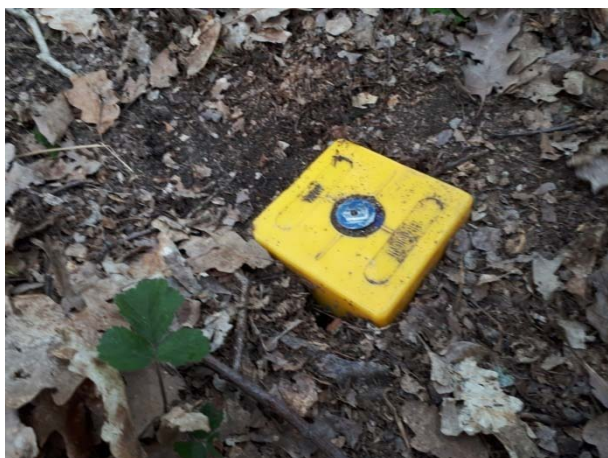
Roh DP fixovaný geodetickým mezníkem
