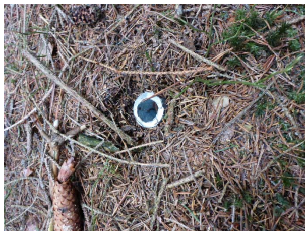
Fotobod fixovaný ocelovou trubkou
