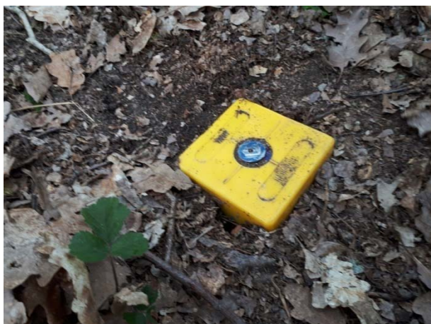
Roh DP fixovaný geodetickým mezníkem
