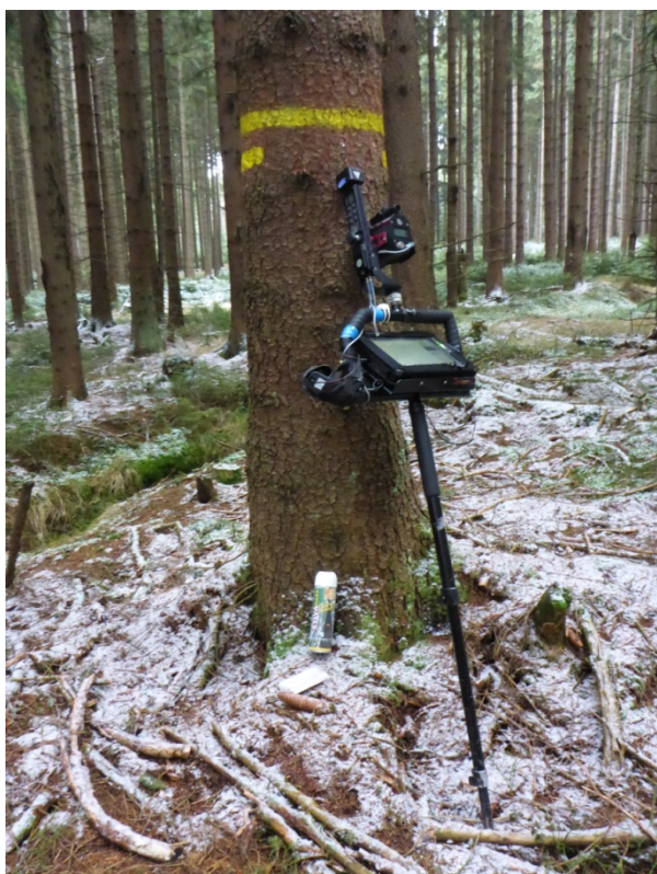
Dvěma pruhy označený strom poblíž rohu DP, měřická souprava Field-Map
