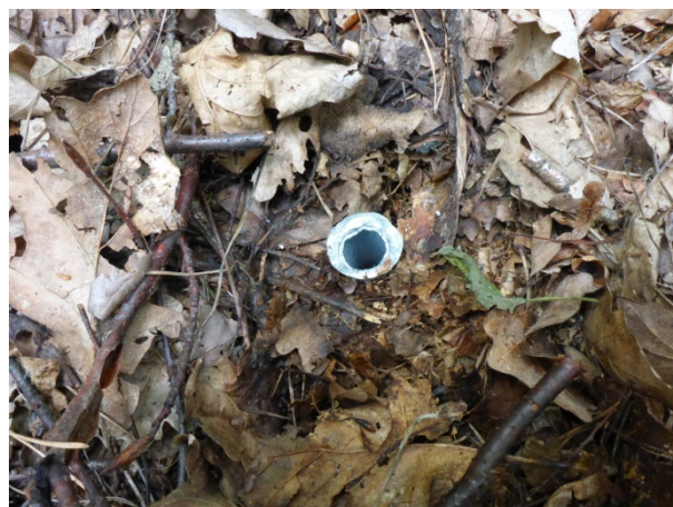
Fotobod fixovaný ocelovou trubkou
