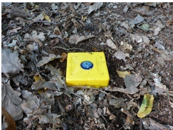
Roh DP fixovaný geodetickým mezníkem
