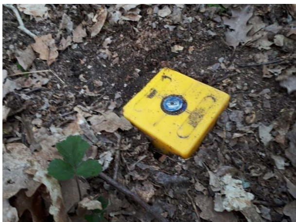
Roh DP fixovaný geodetickým mezníkem
