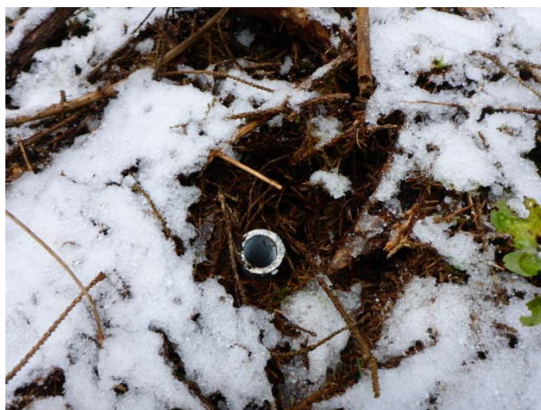
Fotobod fixovaný ocelovou trubkou
