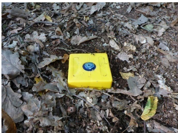
Roh DP fixovaný geodetickým mezníkem
