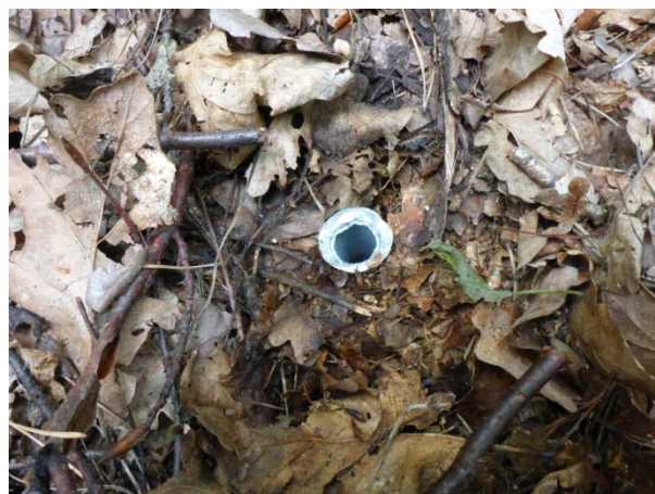
Fotobod fixovaný ocelovou trubkou
