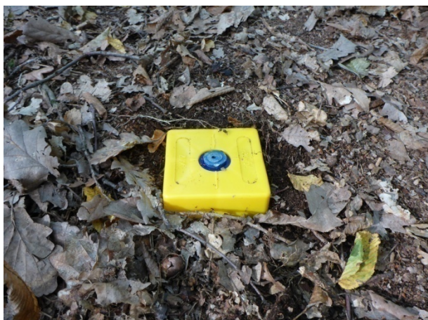
Roh DP fixovaný geodetickým mezníkem
