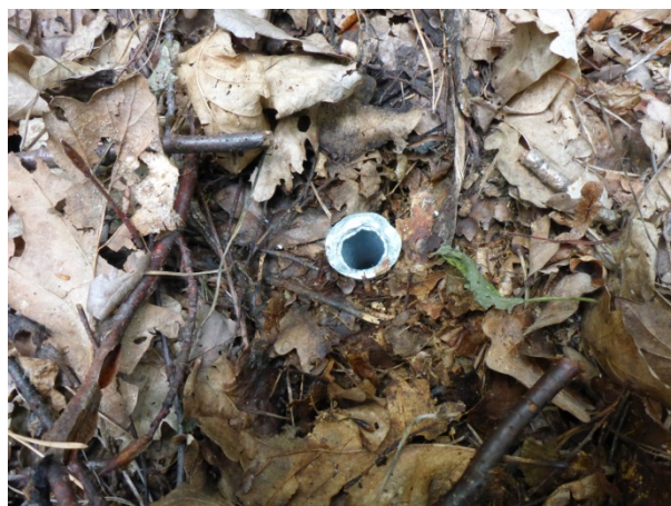
Fotobod fixovaný ocelovou trubkou
